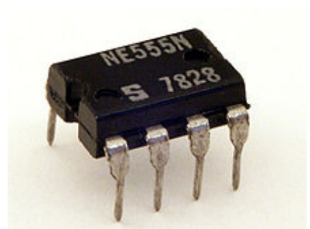
Внешний вид таймера NE555N (буква N обозначает тип корпуса — PDIP8)
